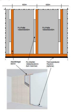
Sie sollten die komplette Fläche zwischen den Akustikriegeln mit den Schalldämmmatten auskleiden, damit keine Lücken entstehen durch die der Schall durchdringen kann. Die Höhe der Akustikriegel und die Schaumstoffplatten können Sie selbst zuschneiden (die Akustikriegel z.B. mittels Säge oder Stichsäge und den Schaumstoff mittels großer Schere). So können Sie das Set an Ihre Raumhöhe optimal anpassen.
