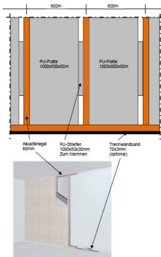
Sie sollten die komplette Fläche zwischen den Akustikriegeln mit den Schalldämmplatten auskleiden, damit keine Lücken entstehen durch die Schall durchdringen kann. Die Höhe der Akustikriegel und die Schaumstoffplatten können Sie selbst zuschneiden (die Akustikriegel z.B. mittels Säge oder Stichsäge und den Schaumstoff mittels großer Schere). So können Sie das Set an Ihre Raumhöhe optimal anpassen.
